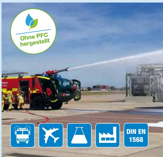
**MOUSSOL®-FF** ist ein alkoholbeständiges, fluorfreies und zu 100 % biologisch abbaubares Schaumlöschmittel. Die Basis bilden spezifische oberflächen- und grenzflächenaktive Inhaltsstoffe, Polymerfilmbildner sowie Schaumstabilisatoren und Frostschutzmittel, die überwiegend aus nachwachsenden Rohstoffen gewonnen werden. MOUSSOL®-FF kann als Schwer-, Mittel- und Leichtschaum eingesetzt werden.
